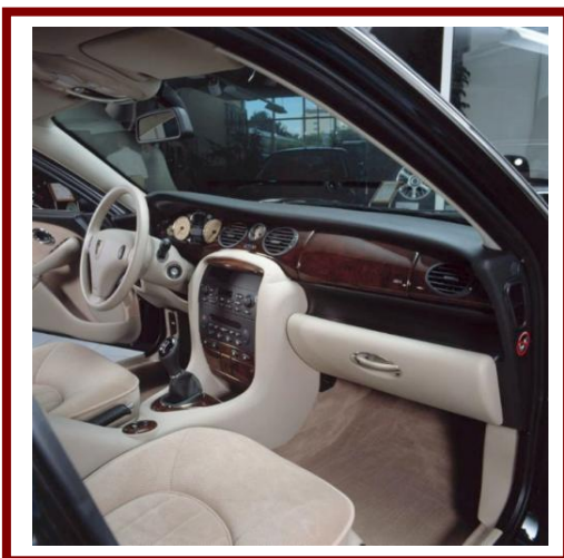
Der besondere Vorteil der Formhäute gegenüber tiefgezogenen Folien ist die Stabilität der Oberflächenstruktur bei der Formgebung.
